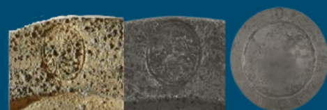
Prato em estanho, segunda metade do século XVII. Antes e pós intervenção com tratamento eletrolítico.
